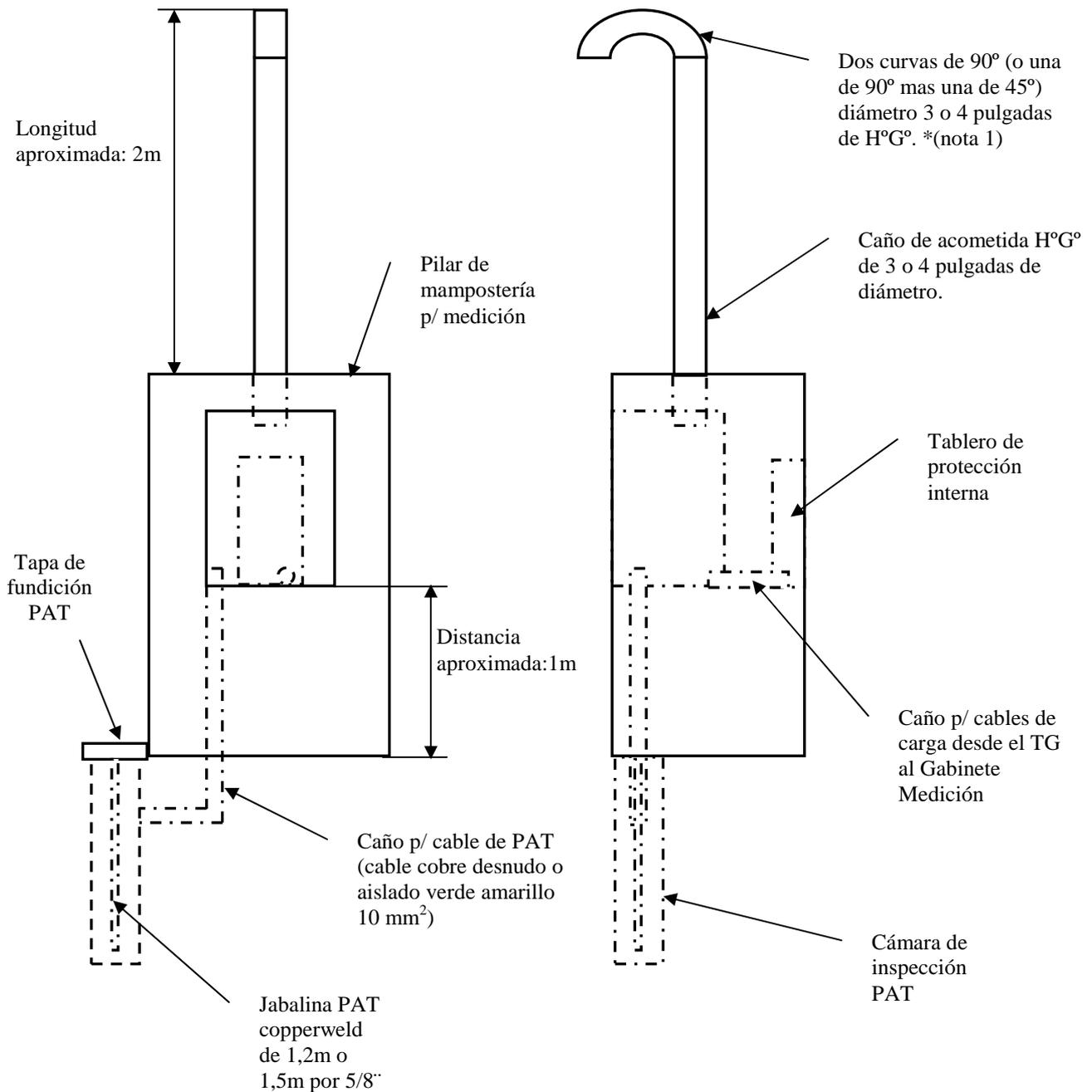
\* Nota 1: La curva del caño de acometida debe permitir el fácil acceso del cable de acometida y a la vez evitar el ingreso de agua hacia el gabinete.
